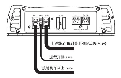
电源线与接地线请用8AWG电缆
